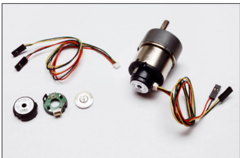
Fig. 4 - Il gruppo motore-motoriduttore che fa muovere il robot.
