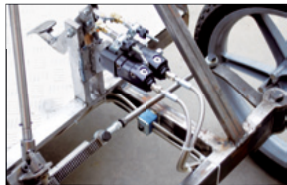
Il comando del freno è ottenuto con un pedale che aziona due pompe.
