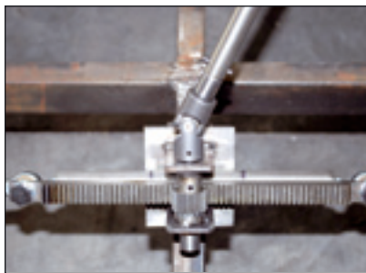
La scatola guida è formata da un'asta dentata su cui è calettato un pignone comandato dal volante.
