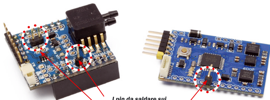
I pin da saldare sui moduli Vshield (a sinistra), e ArduIMU (a destra).
