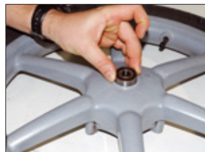
Ogni ruota gira su due cuscinetti mantenuti in posizione da un distanziale e fermati dal dado del mozzo, che mediante una rondella trattiene la ruota stessa.
