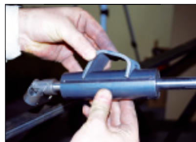
Il piantone dello sterzo ruota su cuscinetti all'interno di un cilindro che gli fa anche da sostegno e permette di fissarlo al cruscotto.
