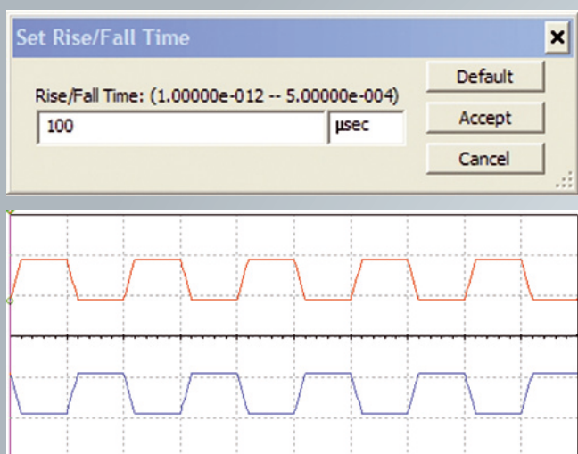
Fig. 9 - Settaggio a 100 \mu\text{s} dei tempi di salita e di discesa e conseguente effetto visivo sull'oscilloscopio.
