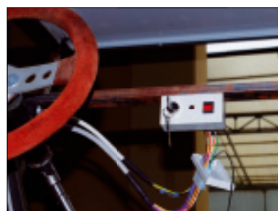
Il quadro con chiave di accensione e selettore avanti/indietro.
