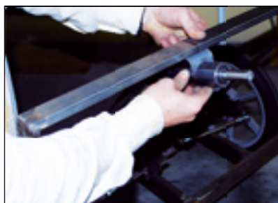
Il piantone dello sterzo ruota su cuscinetti all'interno di un cilindro che gli fa anche da sostegno e permette di fissarlo al cruscotto.
