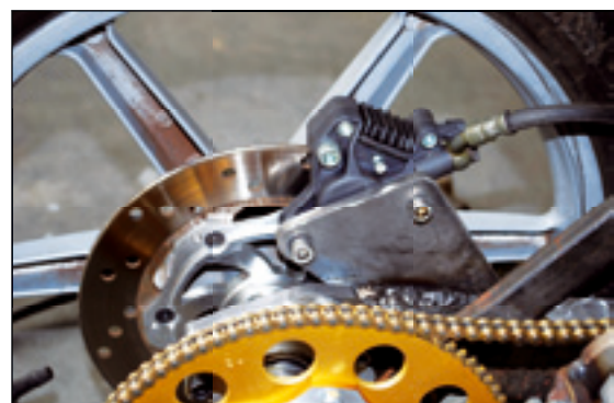
Il freno posteriore è a disco con pinza fissa e disco autoventilante.
