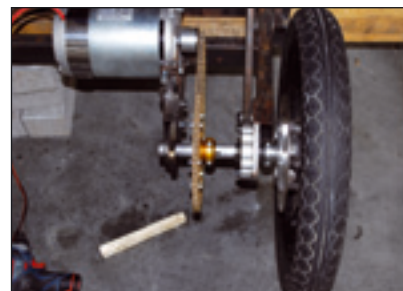
Ogni ruota è mossa dal proprio motore, la cui staffa di sostegno permette di tendere la catena.
