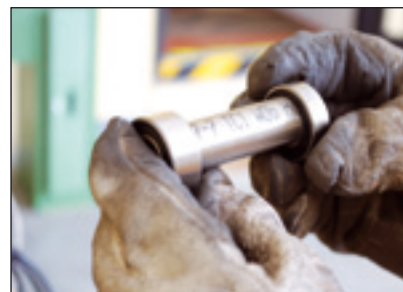
Ogni ruota gira su due cuscinetti mantenuti in posizione da un distanziale e fermati dal dado del mozzo, che mediante una rondella trattiene la ruota stessa.
