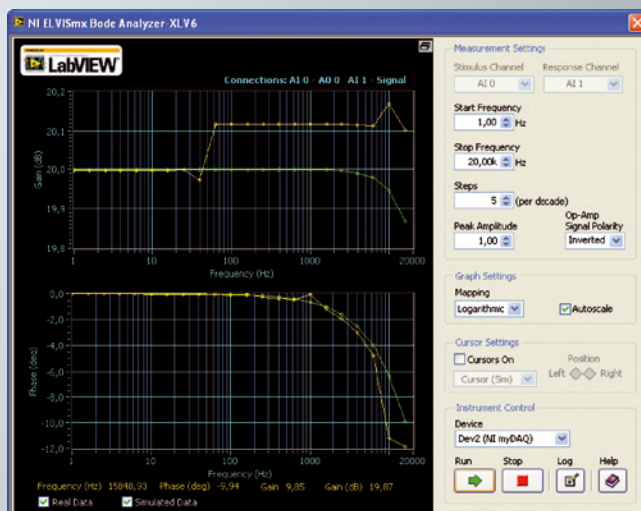
(c) Sovrapposizione dei dati ottenuti dall'analisi reale (grafico di colore giallo) con quelli della simulazione (grafico di colore verde).
