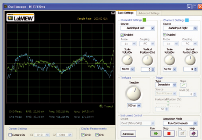
Fig. 7 - Interfaccia dell'oscilloscopio NI ELVISmx durante l'analisi di un brano audio.
