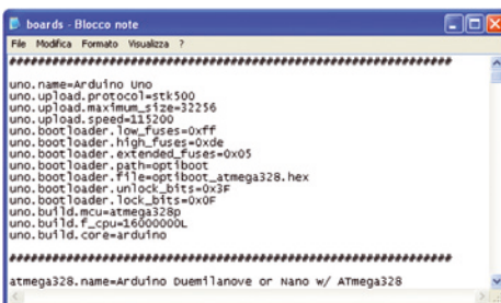
Fig. 9 - La configurazione della board Arduino UNO.
