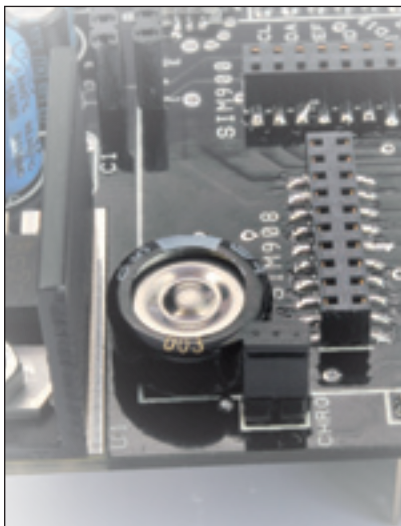
Fig. 4 - Condensatore dedicato all'alimentazione del Real Time Clock.
