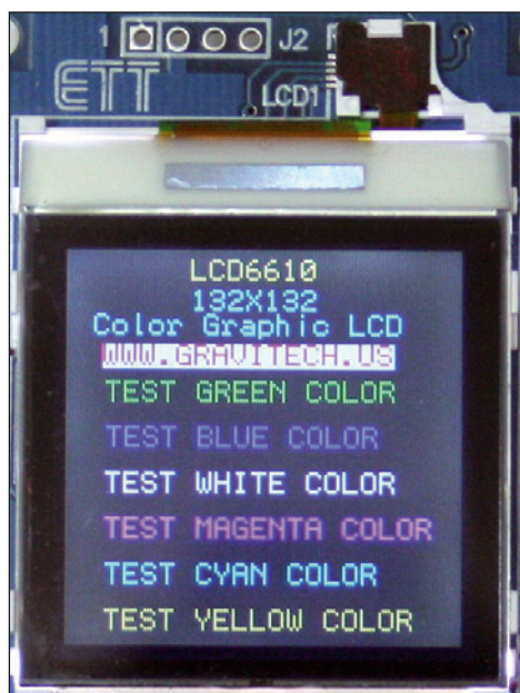
Fig. 2 - Display LCD 130 x 130 pixel colorato con profondità di colore di 12 bit, 4 bit per colore.
