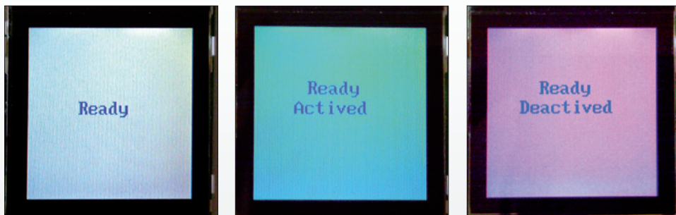
Fig. 4 - La prima immagine da sinistra verso destra mostra lo stato del display dopo che il dispositivo ha terminato l'inizializzazione; proseguendo, la seconda immagine avvisa l'utente che il consenso è stato dato dopo aver accostato una scheda il cui ID è presente nella White list ; infine l'ultima immagine mostra il consenso ad una azione di uscita da un ambiente, o di disattivazione in genere, dopo aver riaccostato la tessera corretta.
