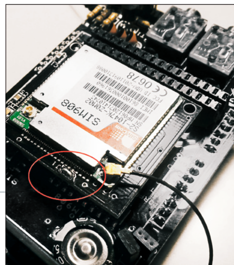
Fig. 1 - Il ponte su J1 dell'FT971 per abilitare l'alimentazione all'antenna GPS.
