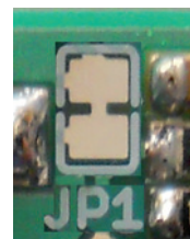
Fig. 4 Il jumper JP1 a saldare posto direttamente sul PCB.
