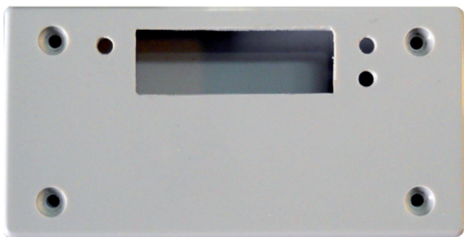
Fig. 6 La mascherina del contenitore dopo la foratura.
