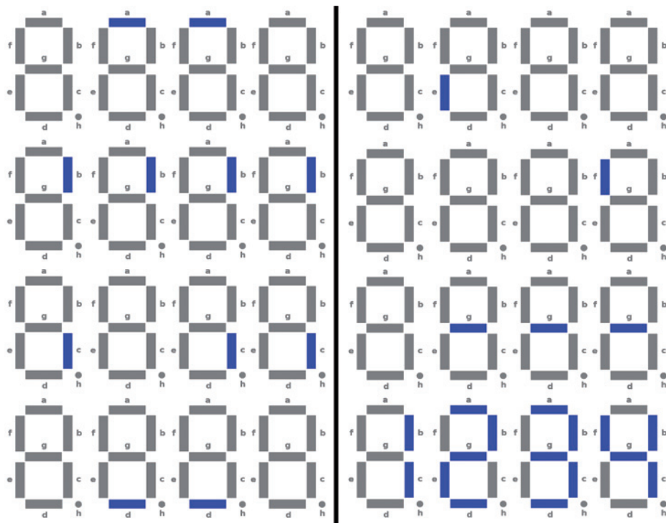
Fig. 5 - Il funzionamento della Modalità 1 del multiplexing
