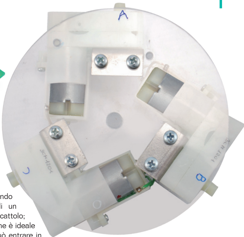
Fig. 8 - Per l'assemblaggio dei motori abbiamo usato tre staffe fissate su un piccolo disco del diametro di 10 cm ritagliato da un foglio di plexiglass.
