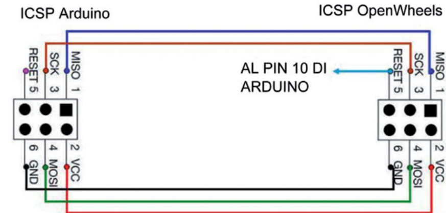
Fig. 1 - Come caricare il bootloader se viene utilizzato un micro Atmel vergine. In questo caso è necessario ricorrere a una board Arduino da usare come programmatore.
