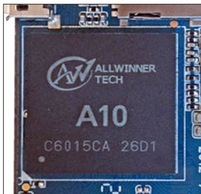
All'interno del mini PC MK802II si trova un SoC Alwinner A10 che contiene un Cortex A8 a 1 GHz e una GPU Mali-400 capace anche di gestire il video 3D.
