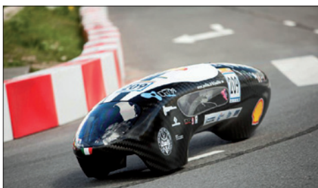
IDRApegasus - 2012 - EUROPEAN SHELL ECO-MARATHON, Rotterdam (Olanda): Percorsi 3023 km/L di benzina equivalente, 337 km/kW.
