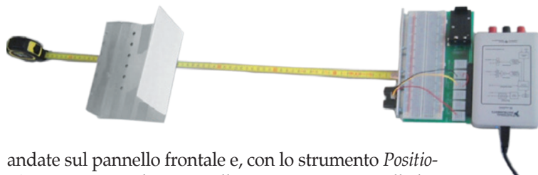
Fig. 12 - Calibrazione del sensore a infrarossi.
