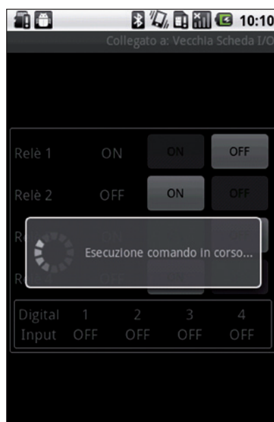
Fig. 5 - L'invio del comando via Bluetooth alla scheda.
