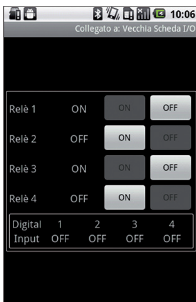
Fig. 4 - La finestra che riepiloga lo stato degli ingressi e delle uscite a relé.
