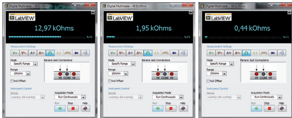
Fig. 2 - Misure di resistenza effettuate con il Digital Multimeter fornito dal NI ELVISmx.
