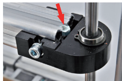
Inserimento vite M5 nella cava superiore del braccio.
