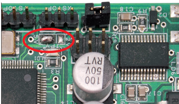
Fig. 8 - Per gestire il servo, dovete chiudere il jumper JPV su 5 V mediante una goccia di stagno.
