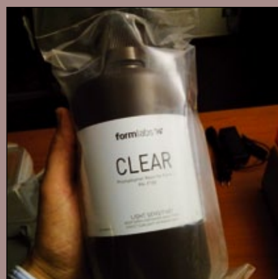
Flacone contenente il liquido polimerico da versare nella macchina per costruire gli oggetti; il liquido è fotosensibile e va quindi protetto dalla luce.
