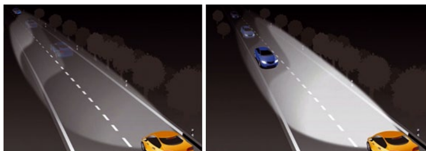
Fig. 2 - Inclinazione regolabile del fascio luminoso con Pixel Light: a) senza sistema AFS, b) con sistema AFS Pixel Light.
