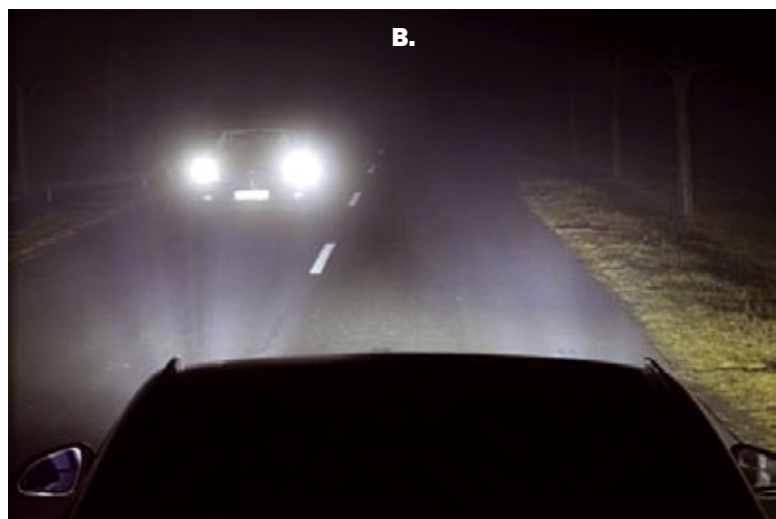
Fig. 3 - Confronto di sistemi AFS: a) con sistema anti-glare Pixel Light, b) senza sistema anti-glare Pixel Light.
