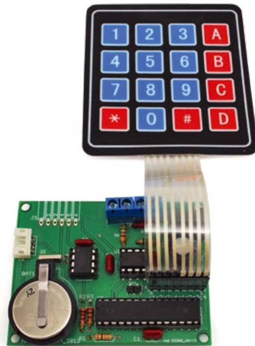
Fig. 4 - Collegamento tra centralina Master e Keypad.
