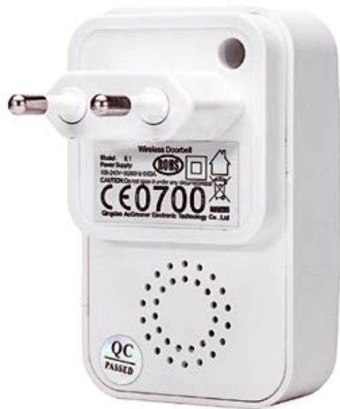
Retro dell'unità ricevente: si nota la spina integrata per l'alimentazione da rete, che fa anche da sostegno.
