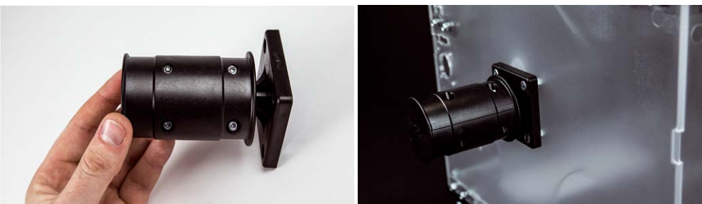
Fig. 14 - Sostegno girevole completato.
