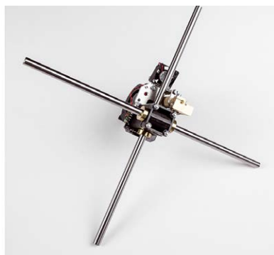
Fig. 31 - I tondini guida vanno introdotti nei fori del supporto della testa e fatti entrare nei cuscinetti delle pareti.
