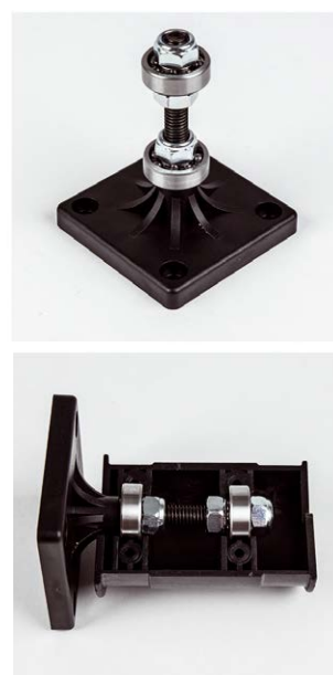
Fig. 13 Applicazione del secondo cuscinetto e di metà del supporto girevole.
