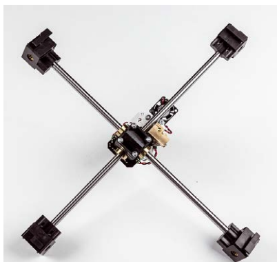
Fig. 31 - I tondini guida vanno introdotti nei fori del supporto della testa e fatti entrare nei cuscinetti delle pareti.
