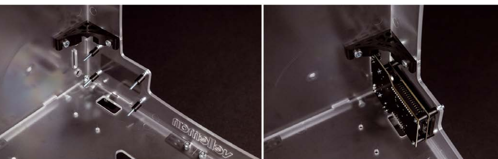
Fig. 15 - Montaggio del pannello di controllo della stampante.
