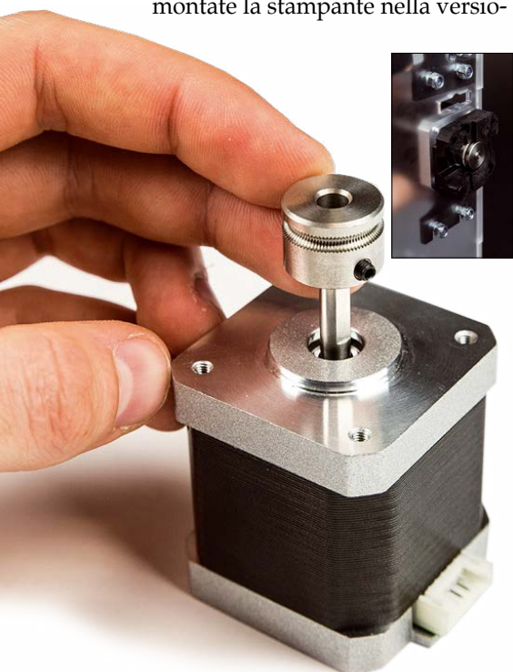
Fig. 23 - Montaggio dello stepper-motor di alimentazione del filamento.
