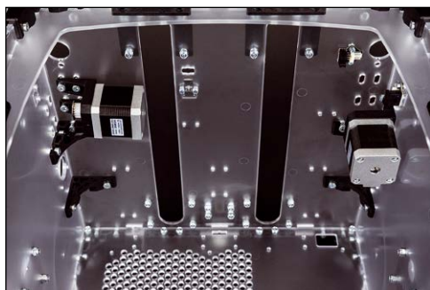
Fig. 21 - Posizionamento degli stepper-motor degli assi X e Y.
