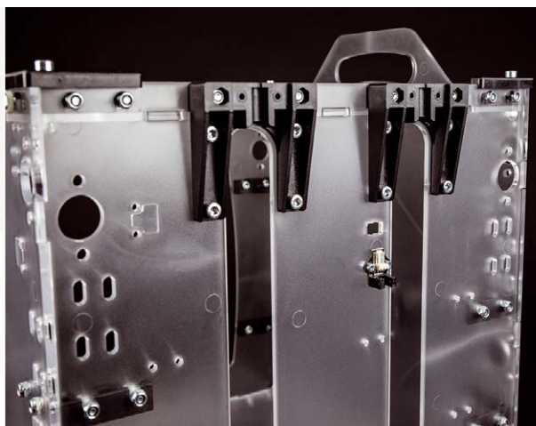
Fig. 17 - Finecorsa con applicati gli isolatori delle viti e montaggio del finecorsa Z.
