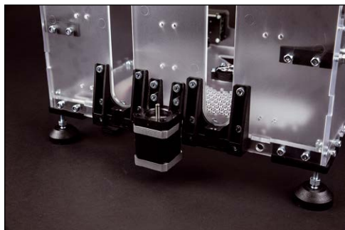
Fig. 22 - Montaggio del motore passo-passo dell'asse Z.
