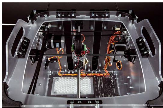
Fig. 32 - Assemblaggio dei tondini guida della testa.
