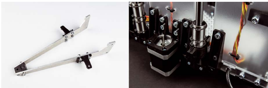
Fig. 35 - Assemblaggio del braccio triangolare e dei sostegni dei cuscinetti lineari.
