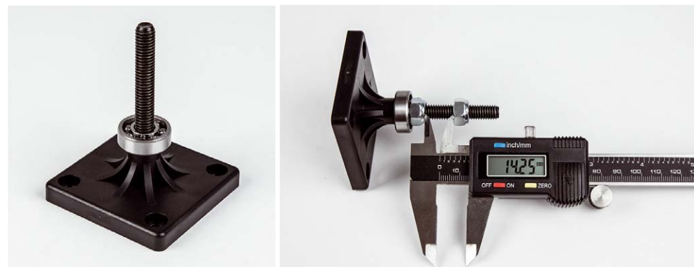
Fig. 12 - Per realizzare il supporto girevole per la bobina si monta sulla base filettata una coppia di cuscinetti separata da dadi autobloccanti.
