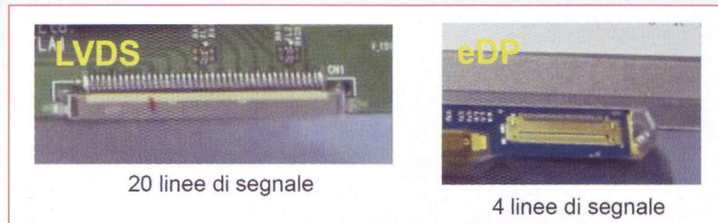
Connettori dei pannelli LCD per notebook e tablet: in alto il tipico LVDS a 40 contatti e in basso il più recente eDP a 30 contatti.
