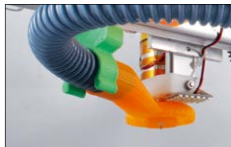
Fig. 9 - Dettaglio del diffusore visto dal basso: si nota l'apertura inferiore.
