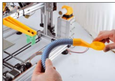
Fig. 8 - Corrugato con applicato il diffusore a ciambella.
