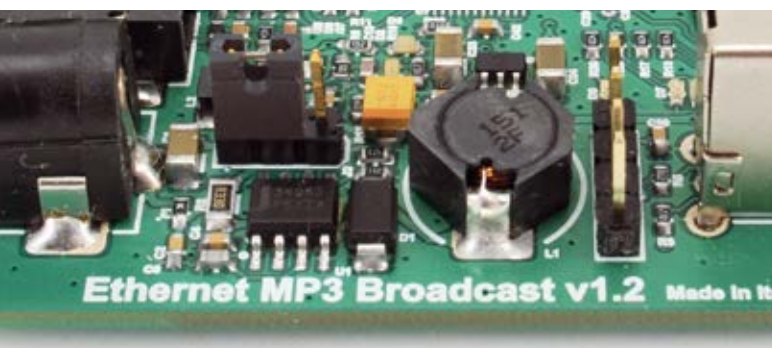
Fig. 2 - Nella figura di sinistra la posizione del jumper consente di alimentare la scheda direttamente con 5 V, invece nell'immagine di destra la scheda può essere alimentata con una tensione compresa tra 7 V e 15 V.
