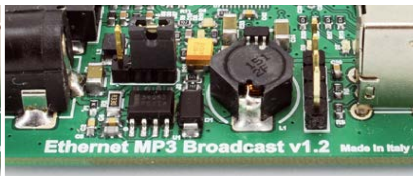
Fig. 2 - Nella figura di sinistra la posizione del jumper consente di alimentare la scheda direttamente con 5 V, invece nell'immagine di destra la scheda può essere alimentata con una tensione compresa tra 7 V e 15 V.
