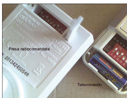
Fig. 8 - Rilevazione dell'indirizzo base nei sistemi Avidsen.
