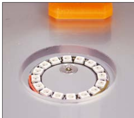
L'anello di LED si applica nel foro sulla parte in plexiglass del carrello.
