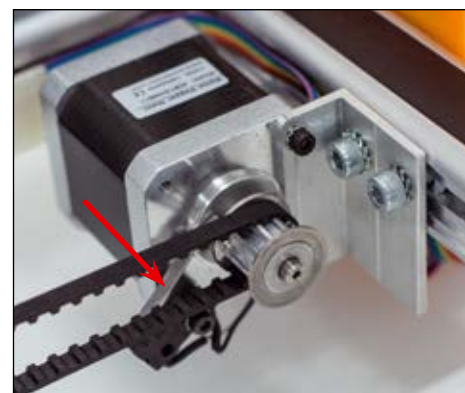
Al motore passo-passo va applicato lo switch finecorsa che verrà azionato dal fermo della cinghia posto nella parte inferiore del carrello.
