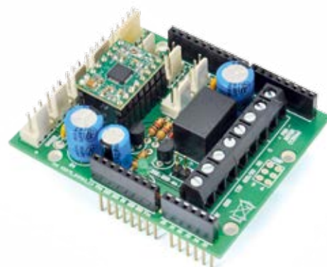
Lo shield realizza l'interfacciamento tra RandA e la parte elettromeccanica della macchina.
