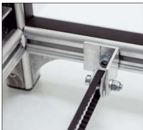
Dal lato opposto a quello del motore, la cinghia scorre su un cuscinetto fissato con una squadretta.
