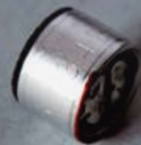
Fig. 1 Capsula electret condenser. La massa è collegata all'involucro.
