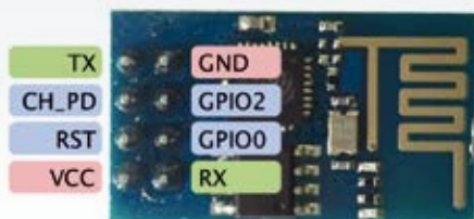
Fig. 2 - Piedinatura del modulo ESP01.
