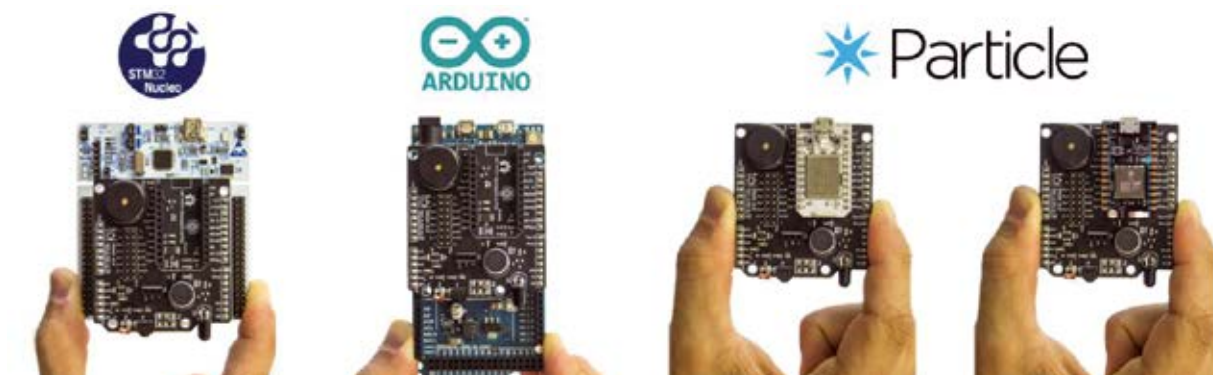
Fig. 3 - TOI Shield è multiboard compatibile.
