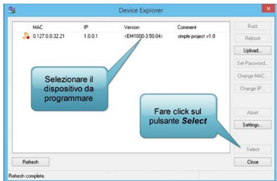
Fig. 7 - Dopo aver collegato il dispositivo da programmare nella stessa rete LAN del PC su cui è installato TIDE, è possibile selezionare il modulo interessato.
