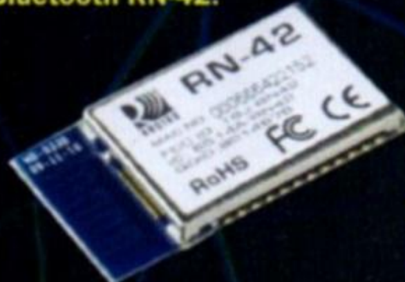
Fig. 1 - Modulo Bluetooth RN-42.
