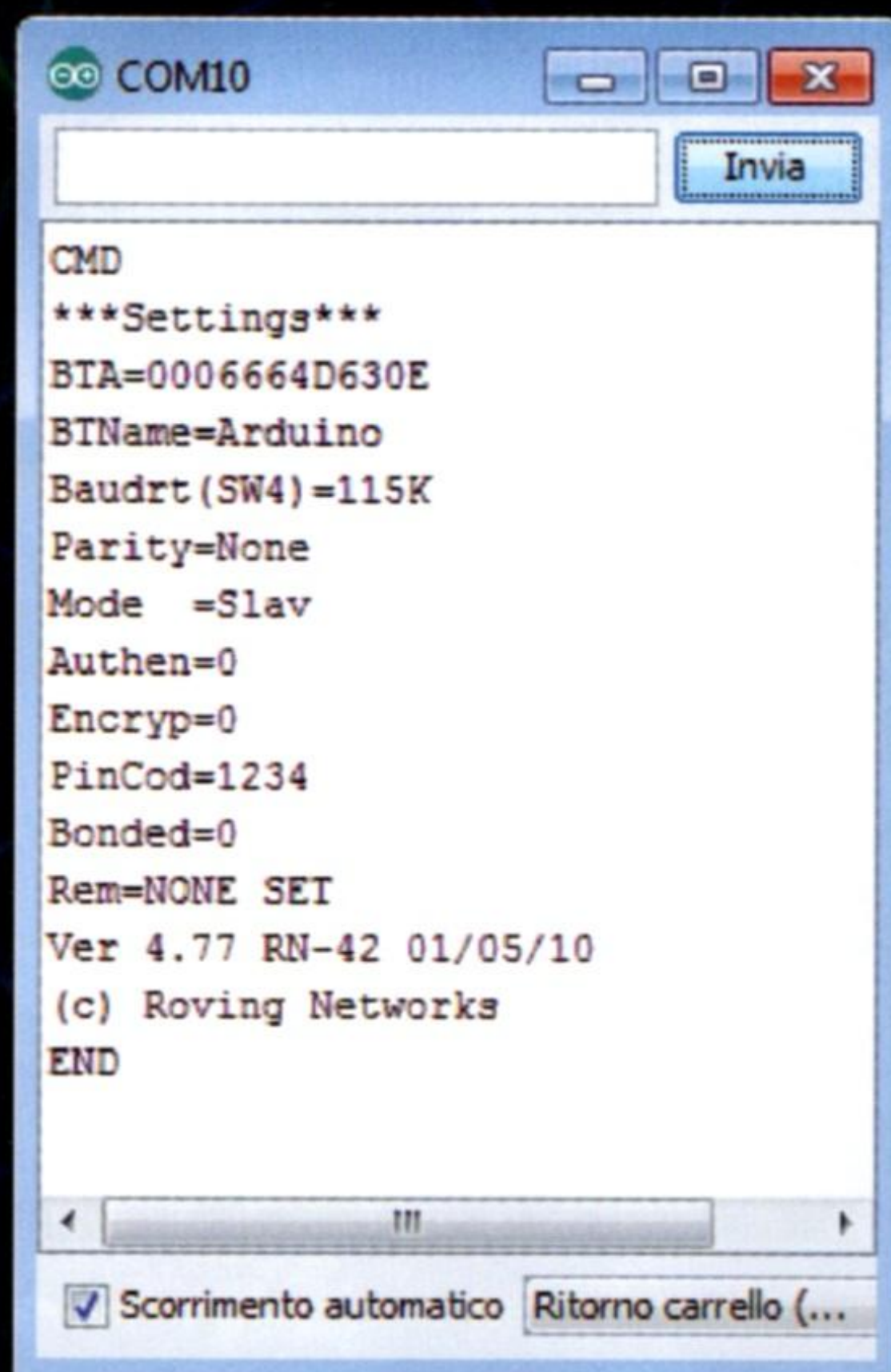
Fig. 5 - Settaggio modulo RN-42.
