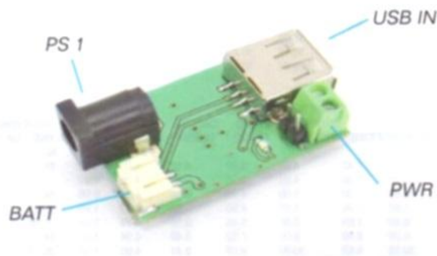
Fig. 1 - Connessioni dell'alimentatore: PWR è l'uscita, BAT l'attacco per la batteria, PS1 l'alimentazione principale e USB IN l'ingresso d'alimentazione da USB.
