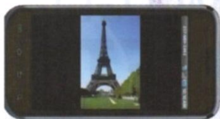
Fig. 1 - Grazie all'accelerometro, lo smartphone capisce in che modo è orientato e adatta l'orientamento di immagini e schermate (Portrait e Landscape Mode).
