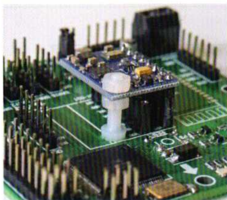
Fig. 5 - Fissaggio modulo IMU alla scheda di controllo.
