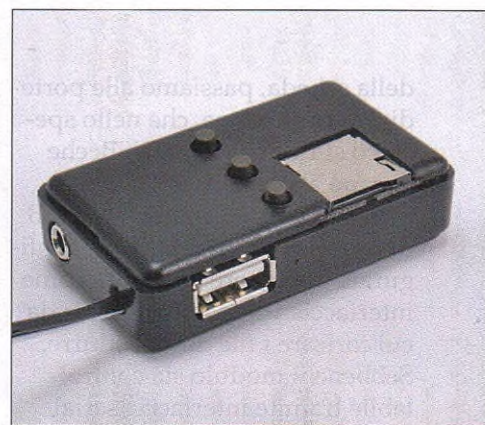
Il lettore MP3 inserito nel suo contenitore, opportunamente lavorato per rendere accessibili la microSD, l'USB e i pulsanti.
