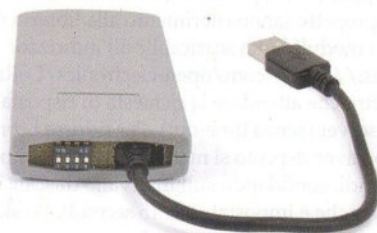
Fig. 2 - A sinistra un'immagine della centralina, qui sotto il Safety Tag (risponditore).
