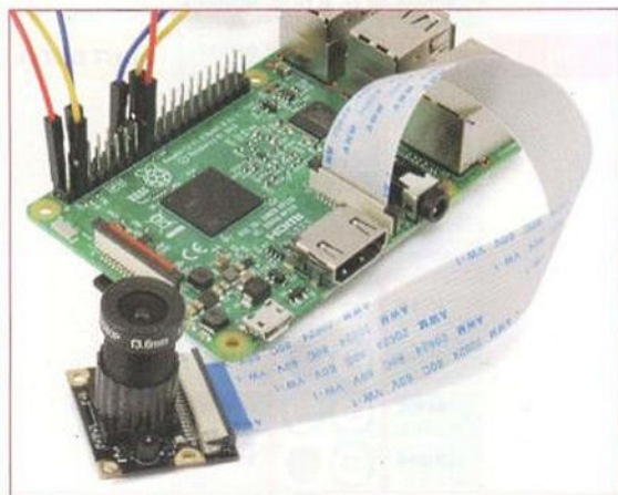
Fig. 4 - Collegamento camera al connettore CSI.
