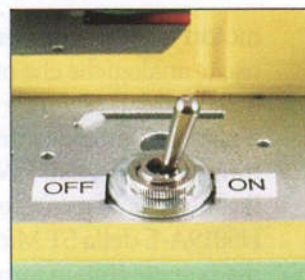
Fig. 4 - L'interruttore di accensione applicato al pianale.
