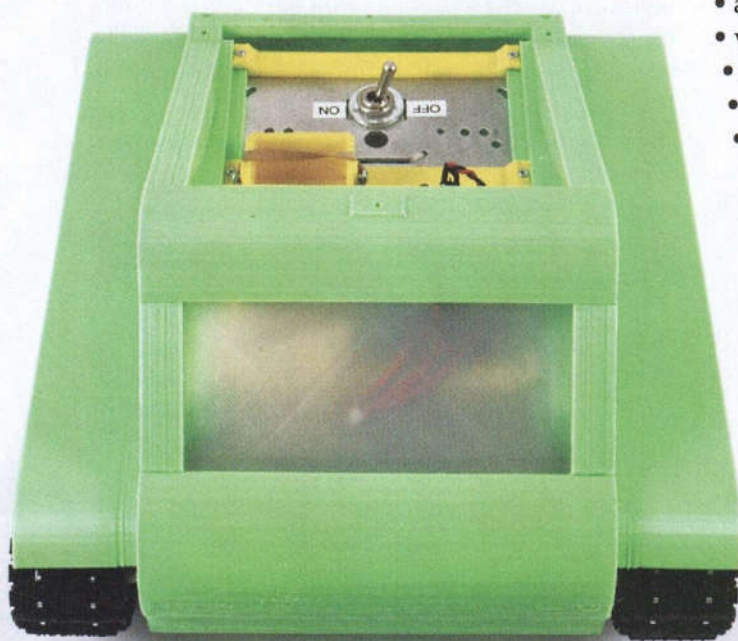
Fig. 2 - Il robot con la carrozzeria stampata in 3D.
