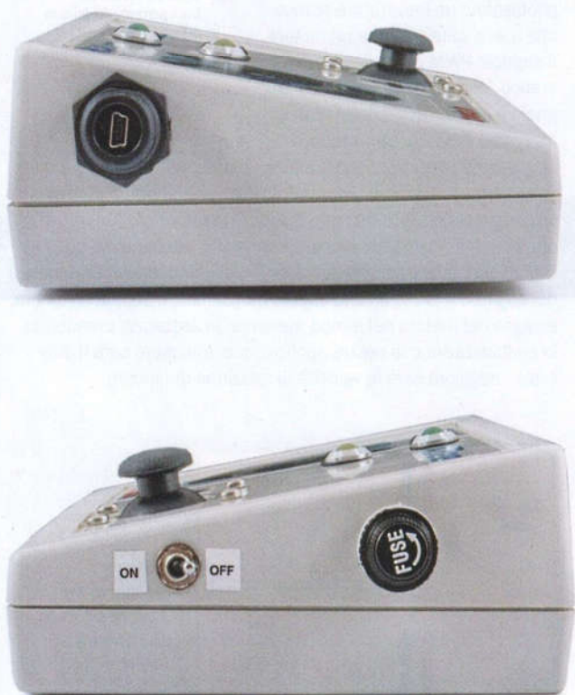
Fig. 9 - Collocazione del fusibile, dell'interruttore on/off e della presa USB.
