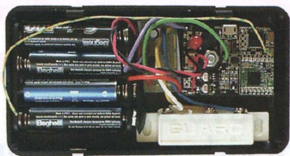
Fig. 6 - Il prototipo del trasmettitore in versione allarme per porte e finestre.
