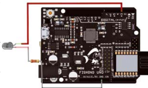
Fig. 5 Fishino collegato al LED IR.
