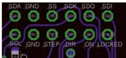
Fig. 8 Piazzole dei collegamenti di segnale.
