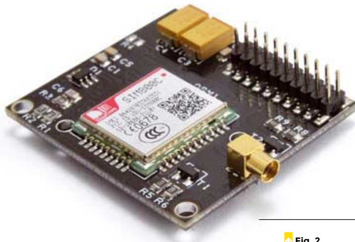
Fig. 2 Il modulo SIM800C montato sulla scheda adattatrice FT1308M.
