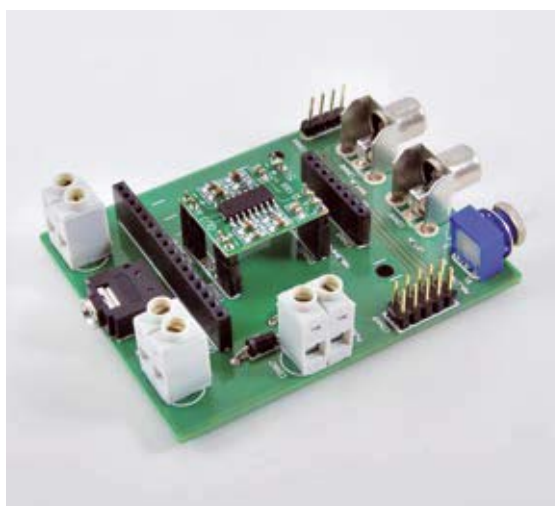
Fig. 2 Insieme della motherboard e del modulo con PAM8403.
