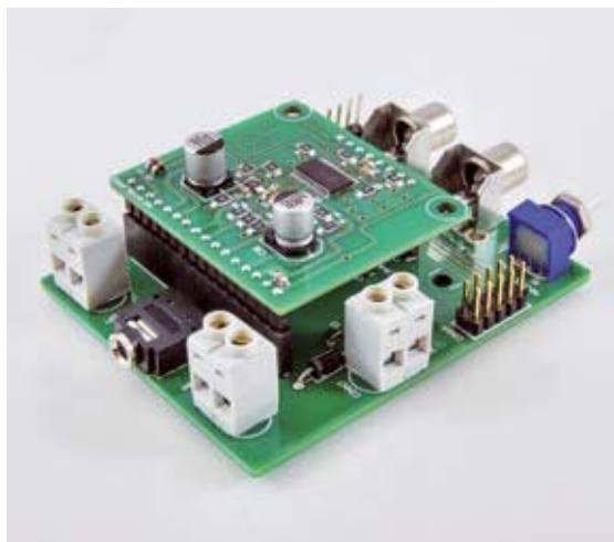
Fig. 1 Insieme di motherboard e modulo con LM4835.
