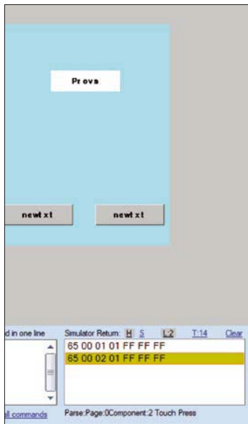
Fig. 8 Simulazione dei messaggi ogni volta che si preme un pulsante.
