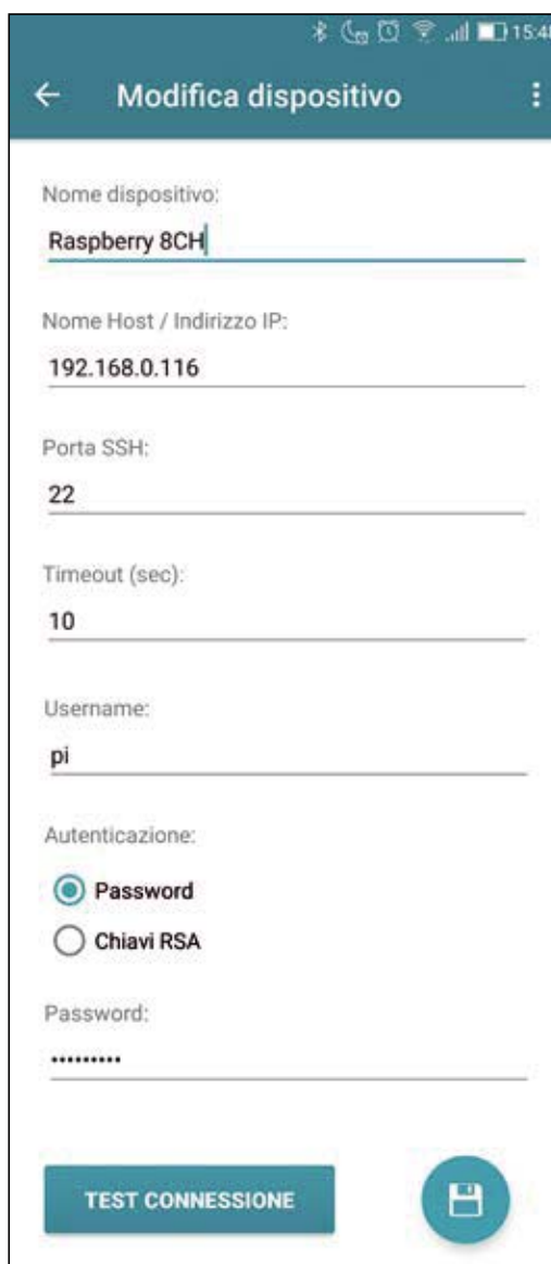
Fig. 10 Compilazione della finestra Modifica dispositivo.
