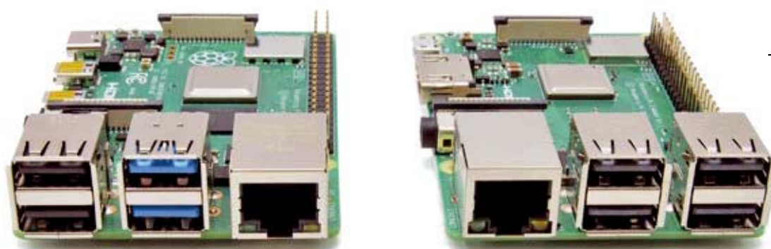
Fig. 2 Confronto disposizione connettori tra Raspberry Pi 4 e 3.
