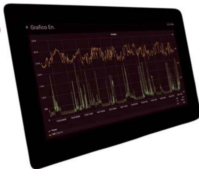
→ Fig. 2 Andamento nel tempo della potenza assorbita e della tensione di rete.
