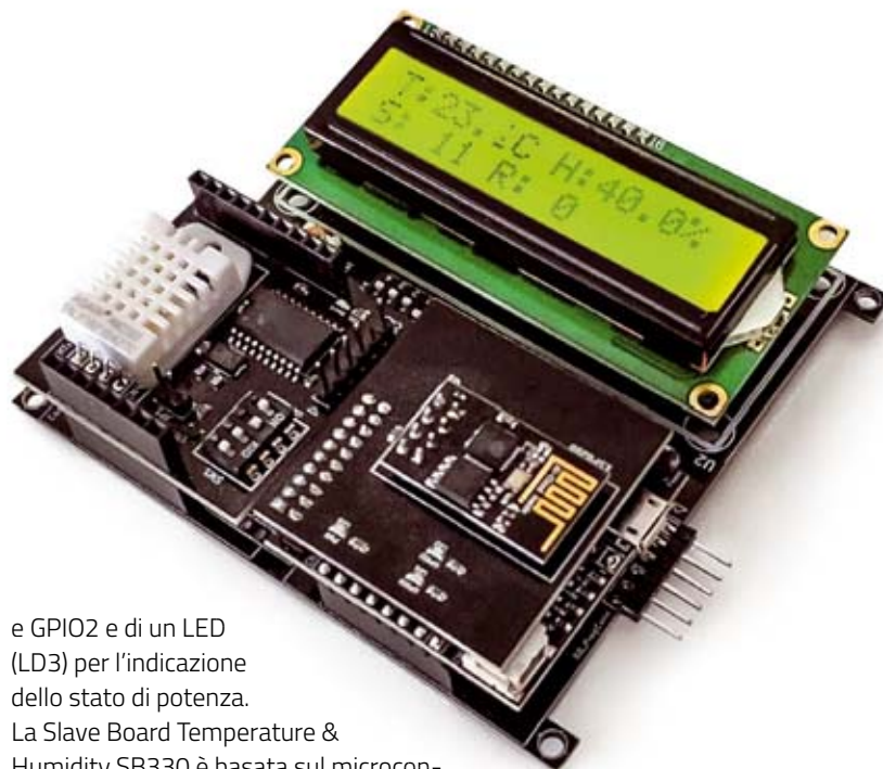
Fig. 3 L'insieme della stazione meteo assemblato.
