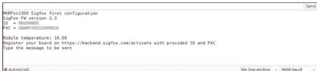
→ Fig. 6 Ricaviamo i parametri ID e PAC dal log seriale.
