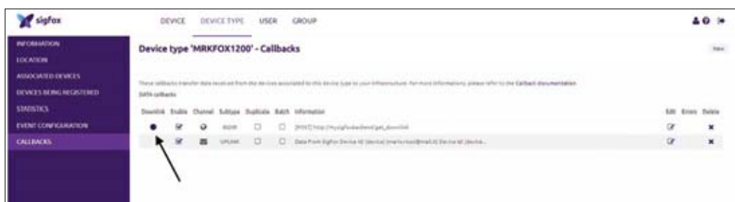
→ Fig. 18 CallBack Bidirezionale abilitata a restituire messaggio di Downlink.
