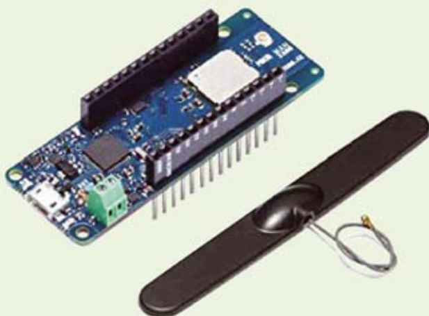
Fig. 4 - Configurazione Hardware per la nostra applicazione basata su LoRa.
