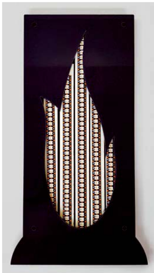
Fig. 2 Come montare le strip di LED Neopixel in modo che una volta accesi riproducano correttamente l'aspetto della fiamma.
