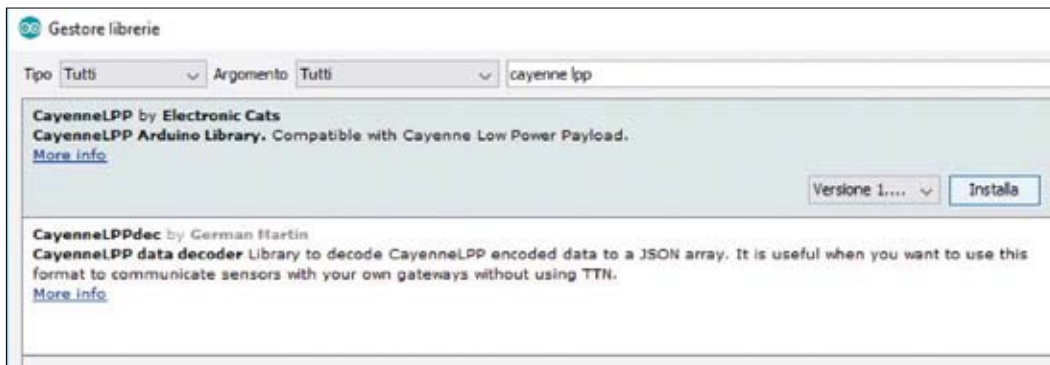
Fig. 8 Installazione libreria CayenneLPP.
