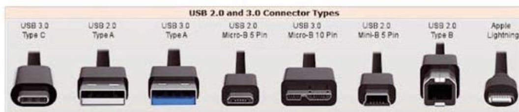
Fig. 5 Connettori USB 2 e 3; il Type-C è anche detto USB-CTM.
