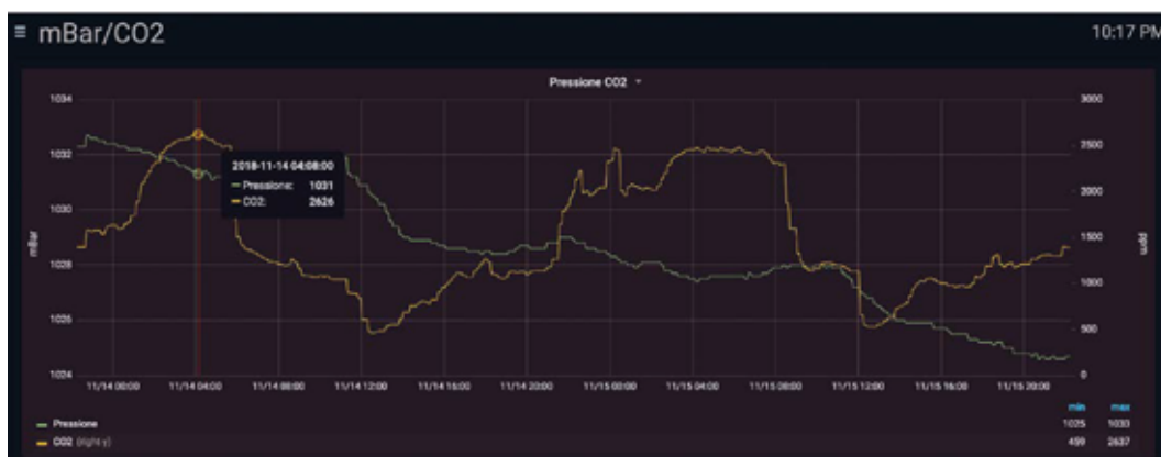
Fig. 12 Andamento nel tempo di pressione atmosferica e concentrazione di anidride carbonica in una stanza da letto.
