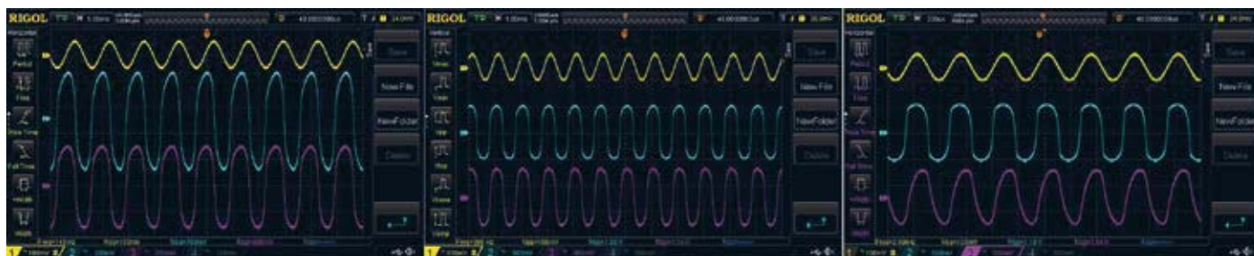
Fig. 14 Forme d'onda con overdrive e toni al massimo.
