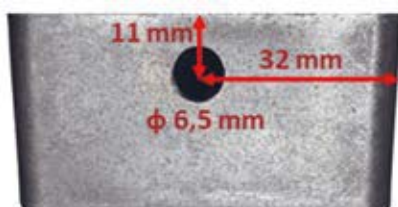
→ Fig. 7 Misure del foro anteriore e delle scanalature laterali.
