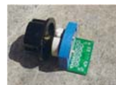
Fig. 2 Il blocco del selettore delle gamme: si collega con tre fili allo stampato base.
