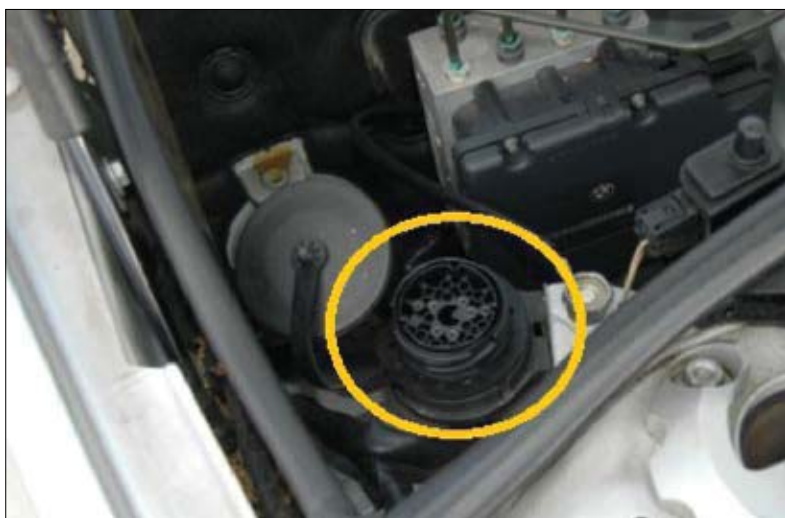
Fig. 4 Connettore di diagnosi BMW.
