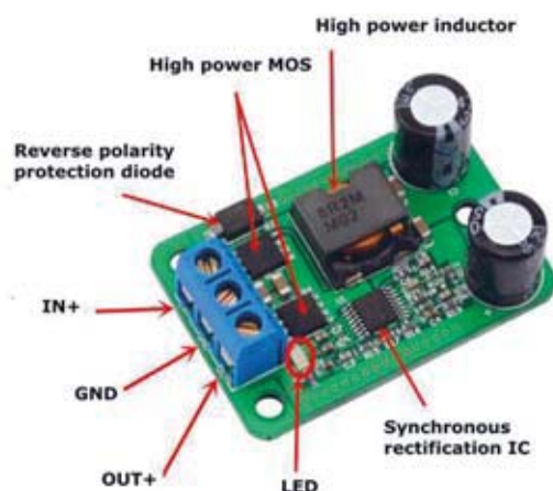
Fig. 7 Il modulo alimentatore basato sul TPS4005.
