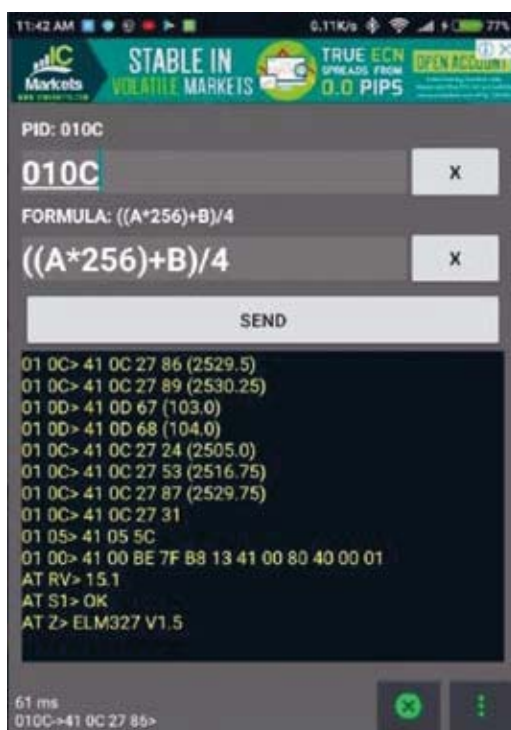
Fig. 10 Due schermate dell'app Terminal ELM327.
