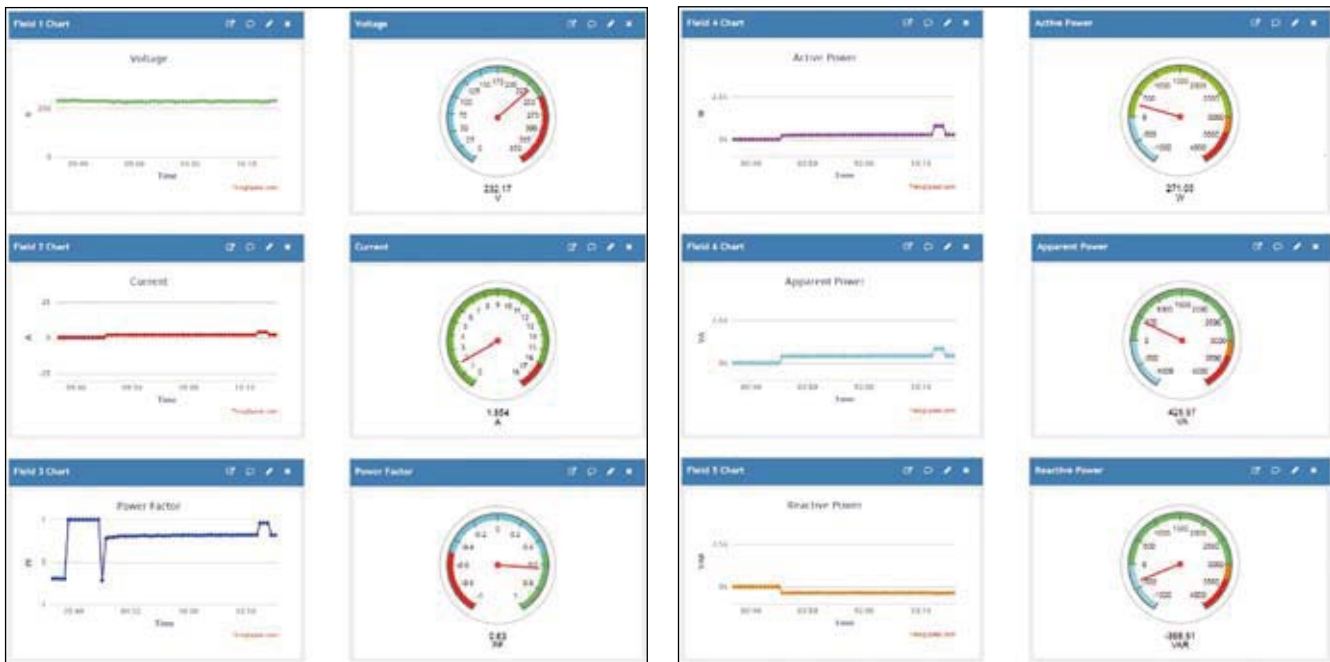
Fig. 9 Visualizzazione di tensione, corrente e fattore di potenza.
