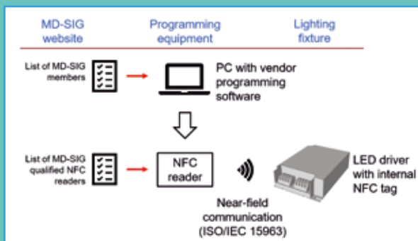
↑ Schema di programmazione dei driver LED tramite NFC.
