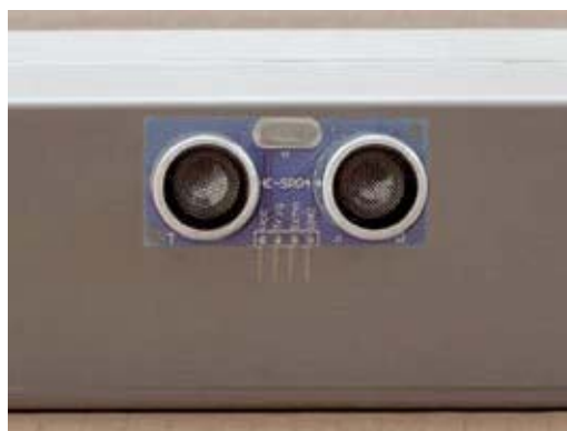
Fig. 2 Il modulo a ultrasuoni si può applicare alla parete frontale del contenitore, facendo fuoriuscire le capsule.
