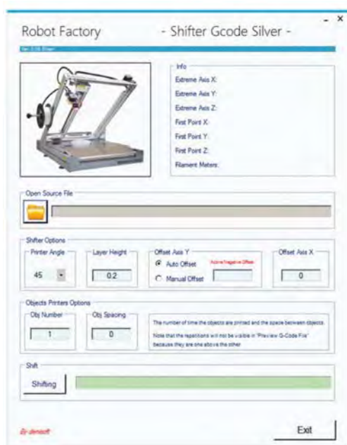
Fig. 24 Traslazione del G-Code tramite lo Shifter.
