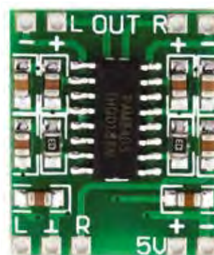
→ Fig. 2 Il modulo amplificatore audio con PAM8403.
