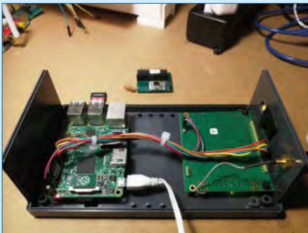
Fig. 5 - Il collegamento tra Raspberry Pi e iC880A.
