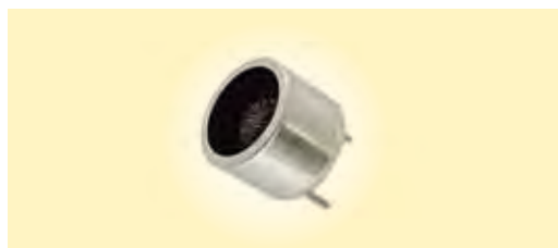
Fig. 5 La capsula a ultrasuoni usata nel progetto.
