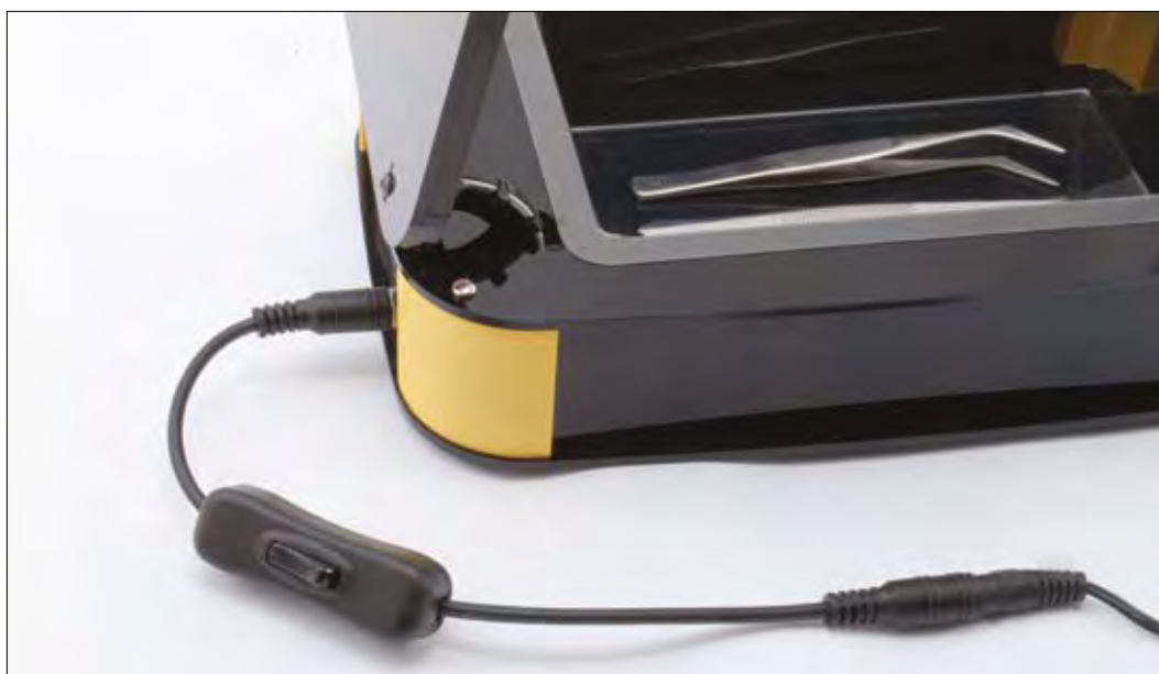
➔ Fig. 8 L'interruttore applicato al cavo di alimentazione.
