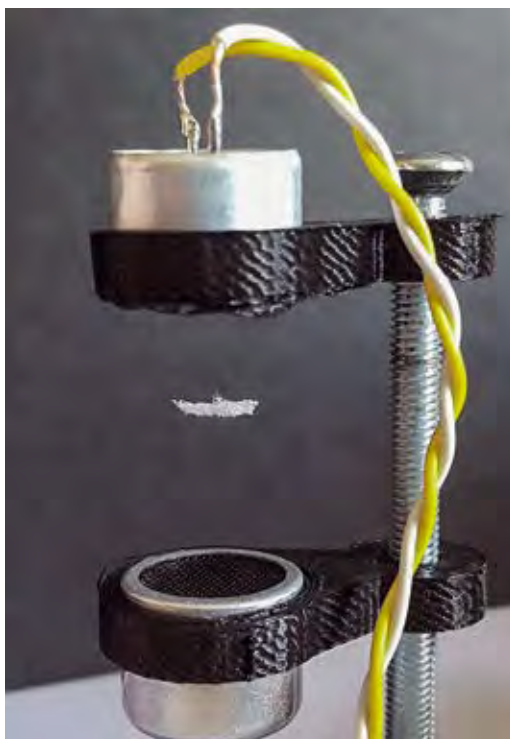
Fig. 8 Levitazione di un piccolo pezzettino di polistirolo.
