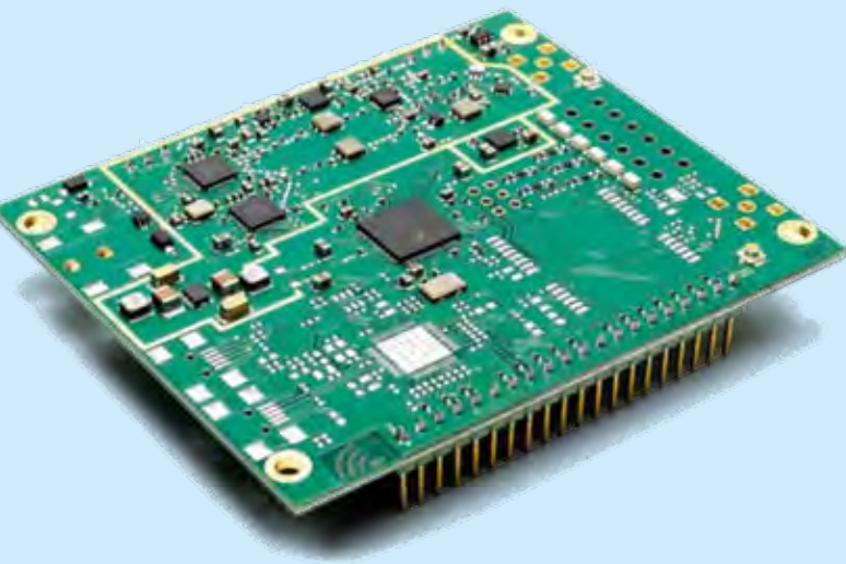
Fig. 1 - Il gateway iC880A-SPI di Wireless Solutions.
