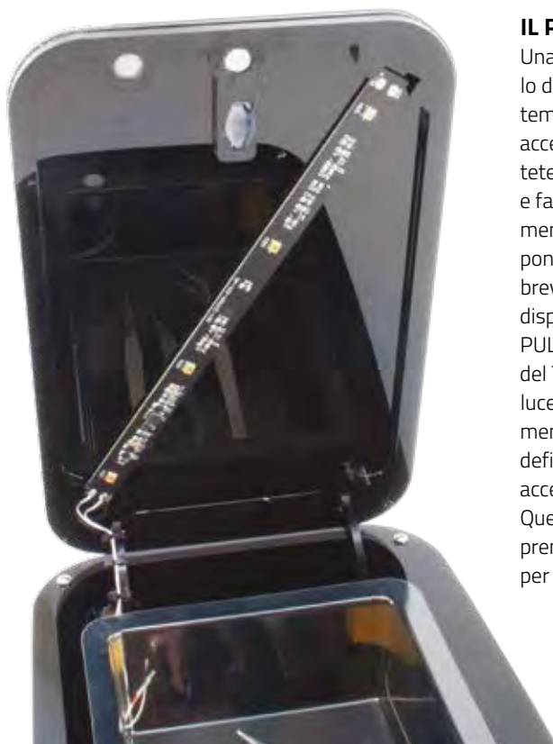
➔ Fig. 9 La strip a LED UV-C applicata all'interno del coperchio in diagonale.
