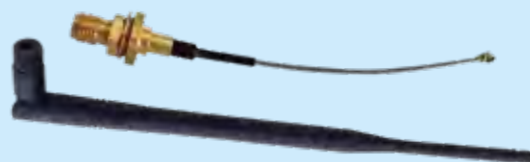
Fig. 6 - L'antenna 868 MHz e il pigtail (adattatore) da U.FL a SMA.
