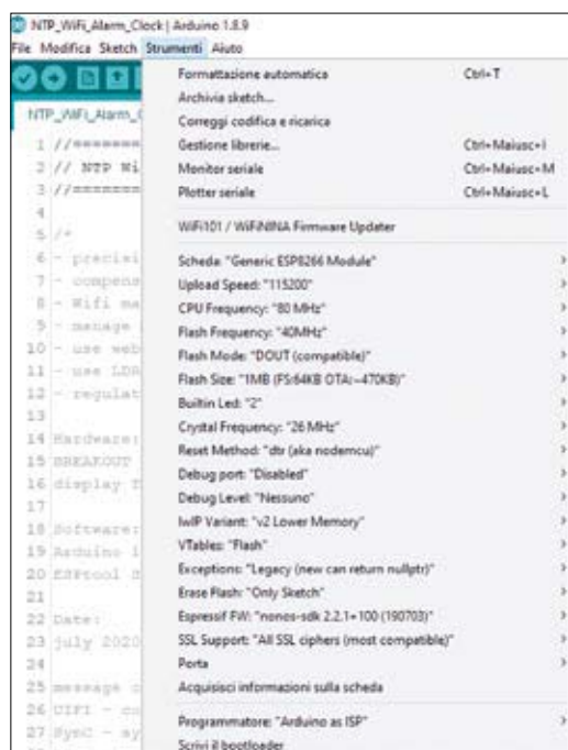
Fig. 10 Impostazione della scheda nell'IDE Arduino.
