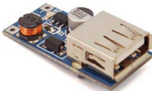
Fig. 4 Il convertitore DC/DC 2846-STEPUPUSB della Futura Elettronica.
