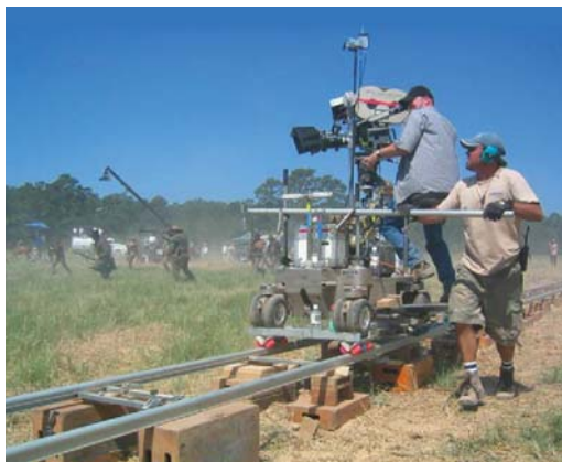
Fig. 1 Una telecamera dolly a movimentazione manuale.
