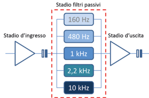
Fig. 5 Schema a blocchi dell'equalizzatore
