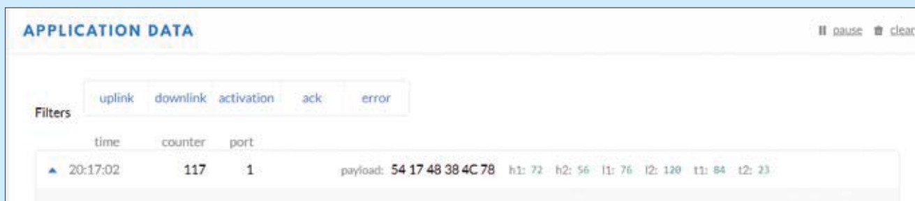
Fig. 13 - La conversione effettuata in base al Decoder del Payload Format.
