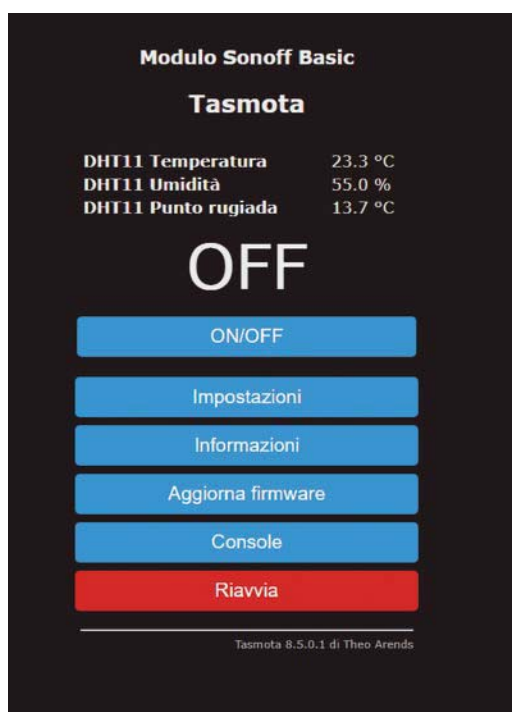
Fig. 5 Visualizza temperatura e umidità su interfaccia tasmota.
