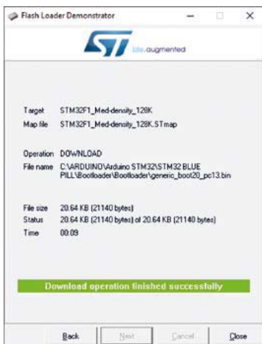
Fig. 11 Software STM32 Flash loader demonstrator caricamento completato.
