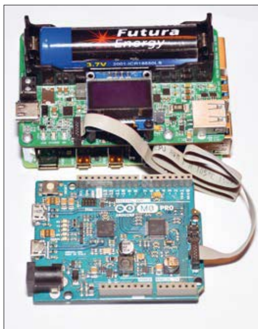
Fig. 7 Programmazione della PowerPi mediante Arduino M0 PRO modificato.
