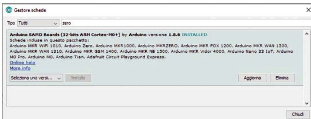
Fig. 4 Installazione pacchetto SAMD Boards.
