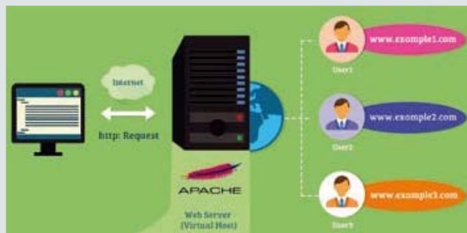
Fig. 2 DNS utilizzato per il servizio virtual hosting.
