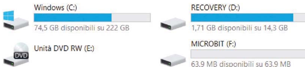
Fig. 1 Una volta connessa, la scheda di Tobbie II dovrebbe apparire tra le risorse del computer come unità a disco MICROBIT.
