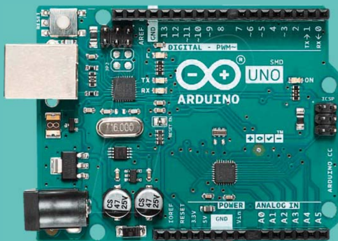
↑ Header e pin-strip degli I/O di Arduino Uno rev.3.
