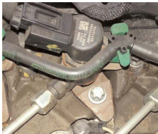
Fig. 8 Codici iniettori piezo scritti sull'attuatore: si tratta di iniettori Siemens VDO A2C59513556.
