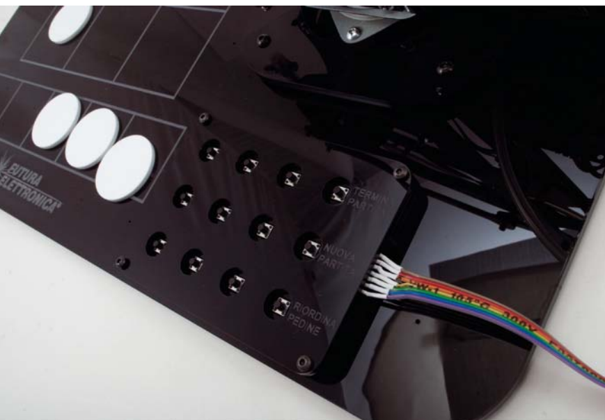
Fig. 1 Tastierino utilizzato dal giocatore con lo schema del tris in miniatura e i tre pulsanti di servizio.
