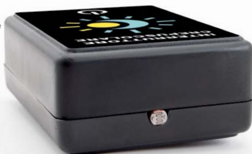
Fig. 1 Il contenitore forato per rendere accessibili fotoresistenza e morsettiere.
