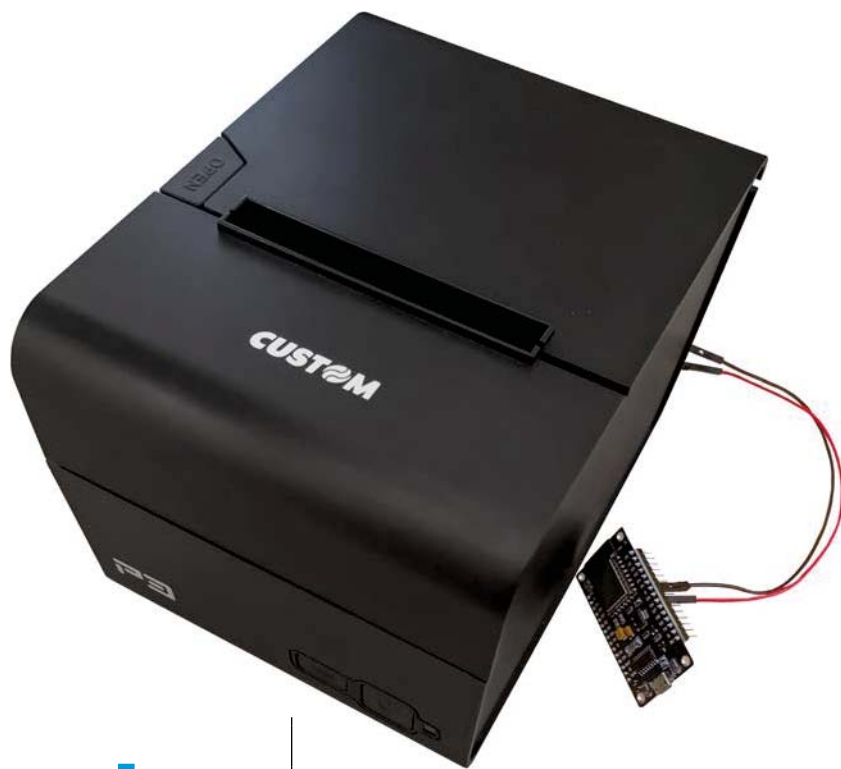
Fig. 1 Stampante P3 connessa in seriale con il NodeMCU ESP8266.
