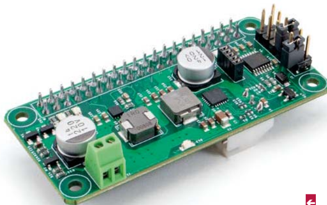
La scheda MiniUPS: si applica alla Raspberry Pi mediante un connettore tipo header.
