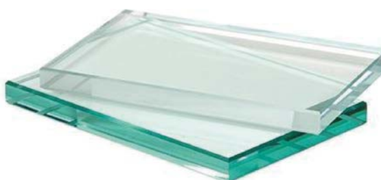
Fig. 3 Lastra di vetro comune (sotto) e lastra museale ultra trasparente (sopra).
