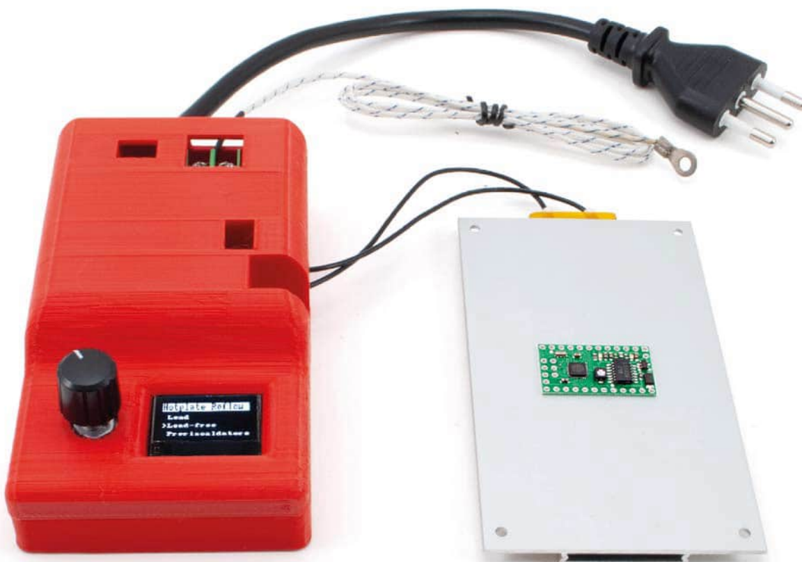
Fig. 4 Il sistema completo: la termocoppia si fissa a vite mediante il relativo occhio.
