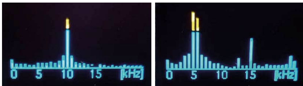
→ Fig. 8 Esempio di un segnale a 10 kHz (a sinistra) e di un segnale a 5 kHz (a destra) visualizzati sull'Oled.
