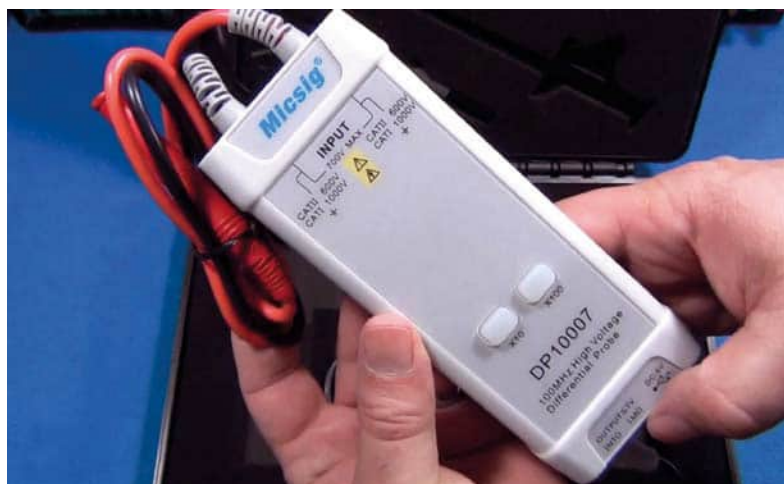
Fig. 4 Sonda differenziale per alta tensione per oscilloscopio da 700V con fattore di attenuazione selezionabile tra 10:1 e 100:1 e banda passante 100 MHz.
