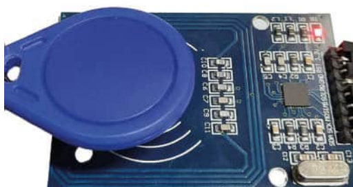
→ Fig. 4 Lettura di un Tag col modulo RC522.
