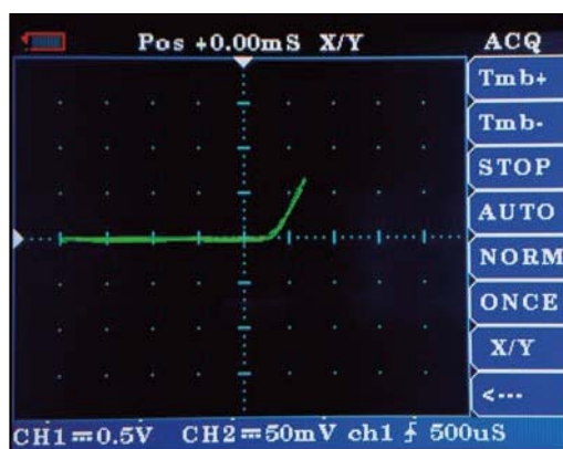
← Fig. 2 Funzione X/Y usata per il test di un diodo.
