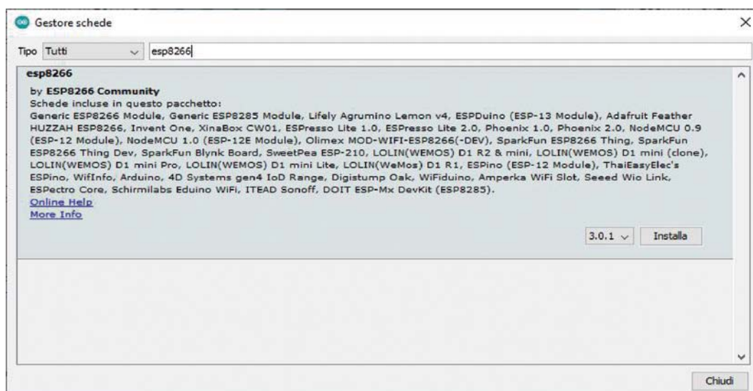
Fig. 5 Installazione pacchetto ESP8266.
