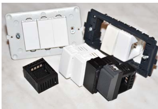
Fig. 19 Contenitori, adattatori e frutti stampati in 3D per placche Vimar Plana, Vimar Idea, Gewiss System, Gewiss Playbus e bTicino.
