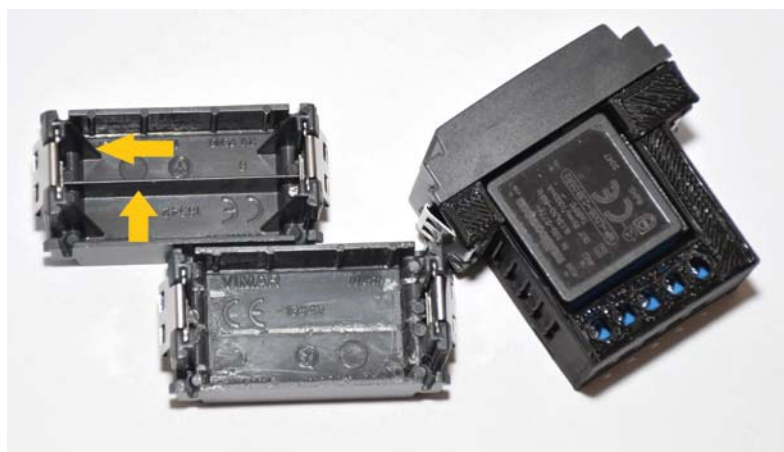
Fig. 20 Le frecce indicano i segmenti di plastica da eliminare sul copriferro.
