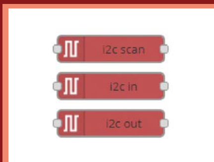
Fig. 14 - Nodi per la gestione dell'interfaccia I2C tramite Node-RED.
