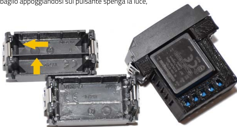
Fig. 14 Le frecce indicano i segmenti di plastica da eliminare sul copriforo.
