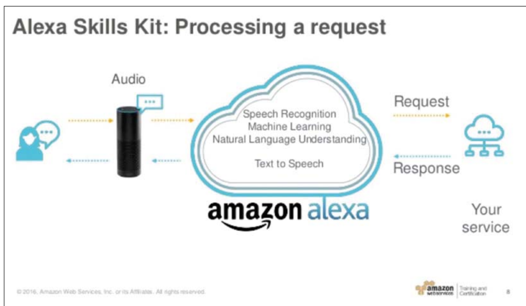
Fig. 1 Schema generale del sistema Amazon Alexa.
