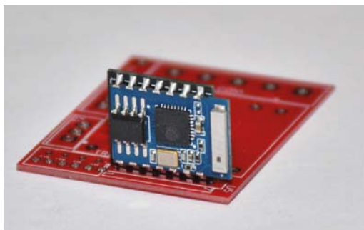
➔ Fig. 1 Montaggio del modulo ESP03 in posizione verticale sul PCB.
