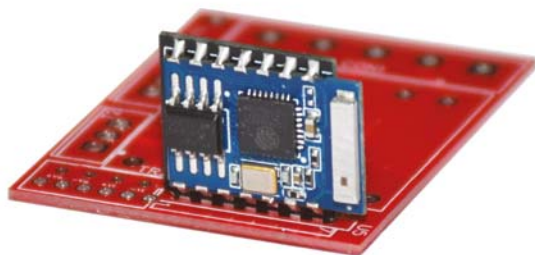
Fig. 1 Montaggio del modulo ESP03 in posizione verticale sul PCB.
