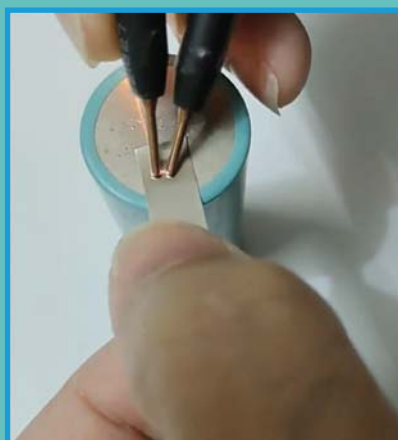
↓ Saldatura con i due puntali sulla lamina da saldare.
