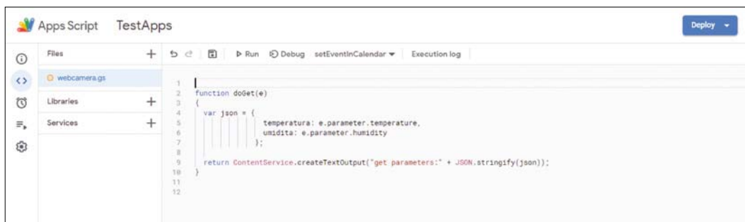
Fig. 4 Esempio di funzione doGet() .
