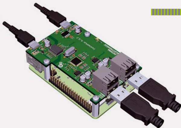
Fig. 9 Assieme scheda RaspberryPi 3B+ e scheda IsoHubUsb.
