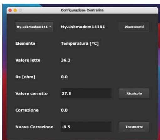
→ Fig. 10 Schermata del PC per la correzione dei valori misurati.
