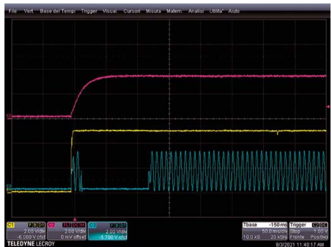
Fig. 6 Assorbimento crescente sulla porta USB fino a intervento protezione.
