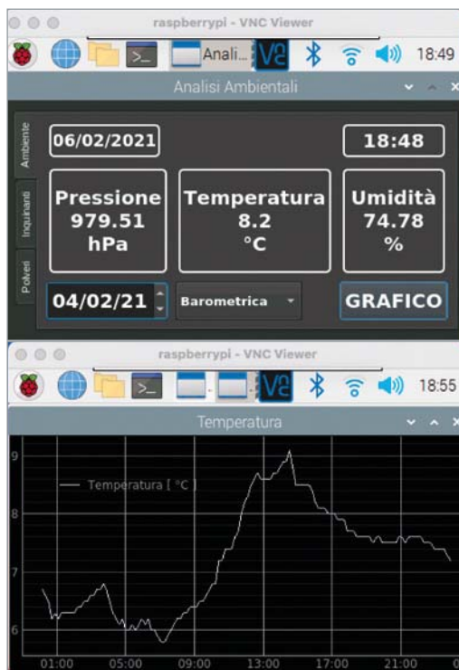
Fig. 13 Software per l'elaborazione dei dati. Attraverso un programma in Python, sfruttando le librerie pyqt5 è possibile l'elaborazione dei dati.
