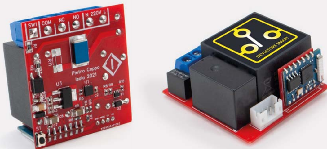
Il prototipo visto dalle due facce del PCB: notare l'ESP03 montato in verticale.
