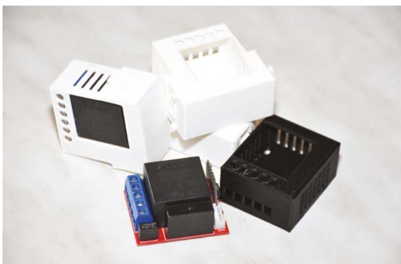
Fig. 11 Contenitori e frutti stampati in 3D per placche Vimar, Gewiss e BTicino.
