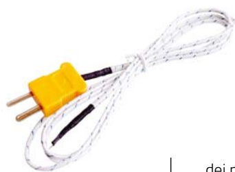
Fig. 10 Tipica termocoppia economica fornita con i multimetri.
